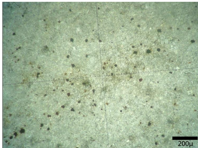
Figure 60: Cristaux de pyrite oxydés en hématite, disséminées dans la matrice de la roche.
