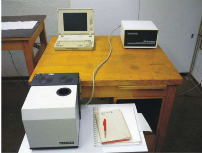
Figure. 2. 1. Susceptomètre Kappabridge KLY3, avec l'unité où l'on place l'échantillon (« pick-up » unit) et l'unité de mesure et l'ordinateur de traitement des données.
