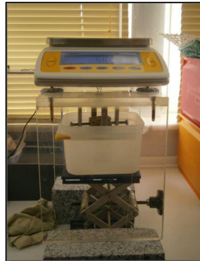
Figure 4.6 : Méthode continue de mesure de coefficient d'absorption capillaire (Benavente et al, 2007)
