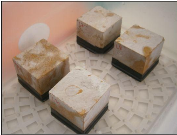
Figure 4.5 : Méthode standards pour la mesure de coefficient d'absorption capillaire EN-1925 (AENOR, 1999)
