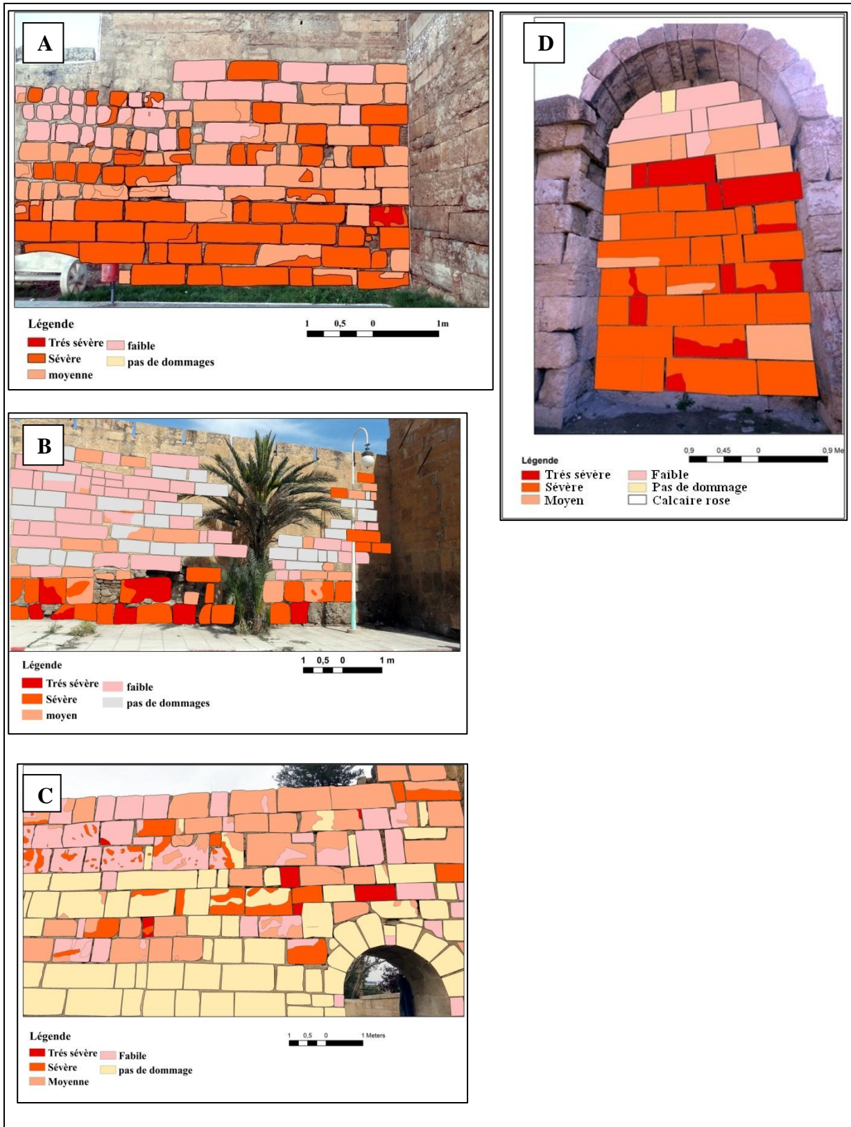
Planche 5. 3 : Cartographies des catégories de dommages au niveau des différentes façades de la muraille, façade Nord (A) Est (B) Sud (C) et de la Basilique (D)
