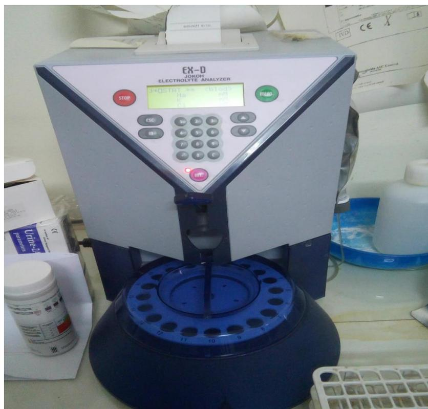
*Photo2 : automate Electrolyte Analyzer– EX-D JOKOH Japon*
